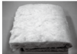
断熱材（グラスウール）
