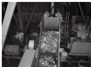
④資源化しやすいように圧縮梱包する工程
