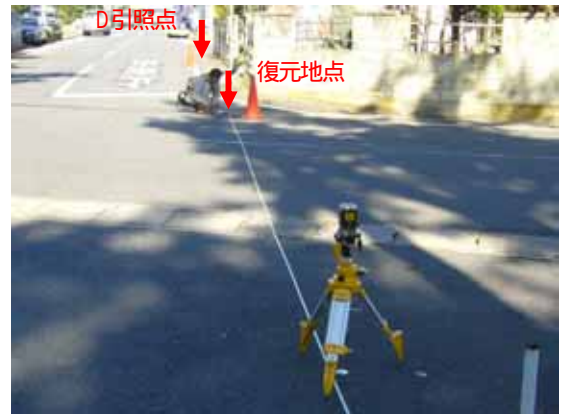
C引照点での基準器による視準(C引照点～復元地点～D引照点)
