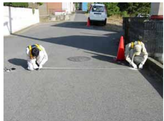
水平距離の測定(D引照点～基準点)
