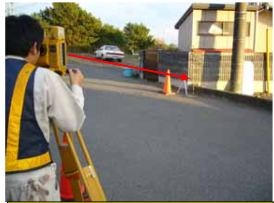
TSによる視準(A引照点～基準点)
