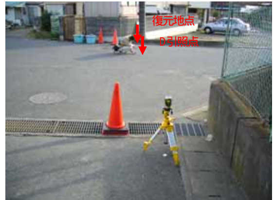
C引照点での基準器による視準(C引照点～D引照点～復元地点)
