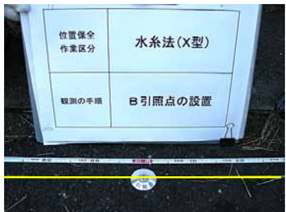
引照点設置後の点検
