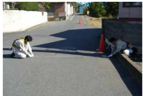
水平距離の測定(D引照点～基準点)
