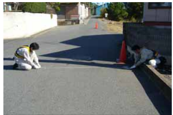
水平距離の測定(D引照点～基準点)
