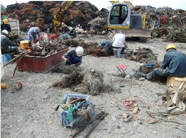
ほとんど手作業で、漁網から鉛や浮きなどを取り除いています。鉛入りの漁網もこの作業により除去されます。丁寧に除去することで、漁網のみにしています。
