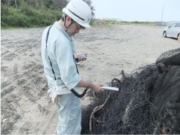
人体に影響がないことを確かめるため、空間線量率を測定しています。細かく測定するため、4方向から測定しています。
