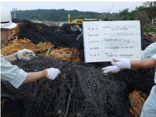
漁網から余計なものが取り除かれた後は、小山(20 m<sup>3</sup>程度)にしてあります。この小山を検査し、安全性を確認していきます。外部の専門機関で分析するため、試料を採取しています。
